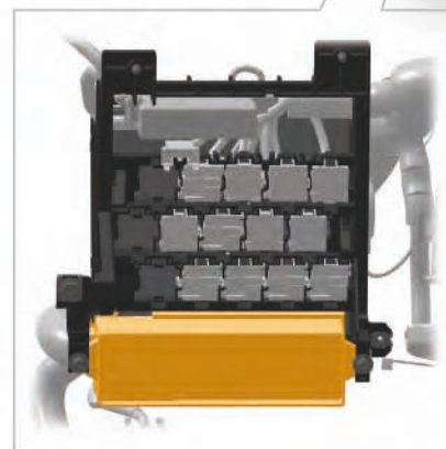
Sicherungsträger an der Vorderseite des Kunststoffgehäuses - unten
